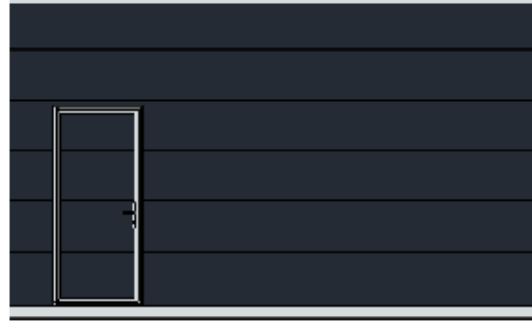
Buitendraaiend, opstelling scharnierpunt: rechts (bij binnenzicht)
